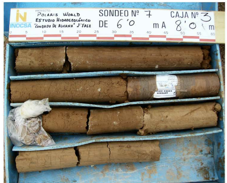
CAJAS DE TESTIGOS DEL SONDEO S-7
