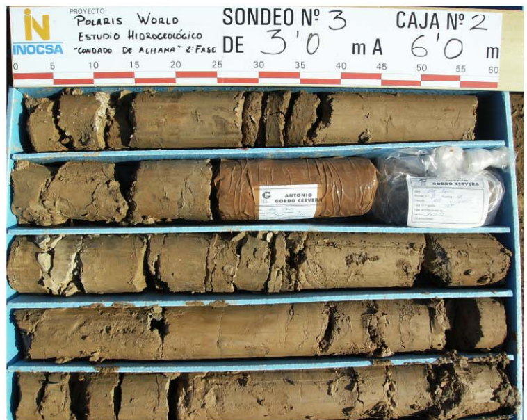
CAJAS DE TESTIGOS DEL SONDEO S-3
