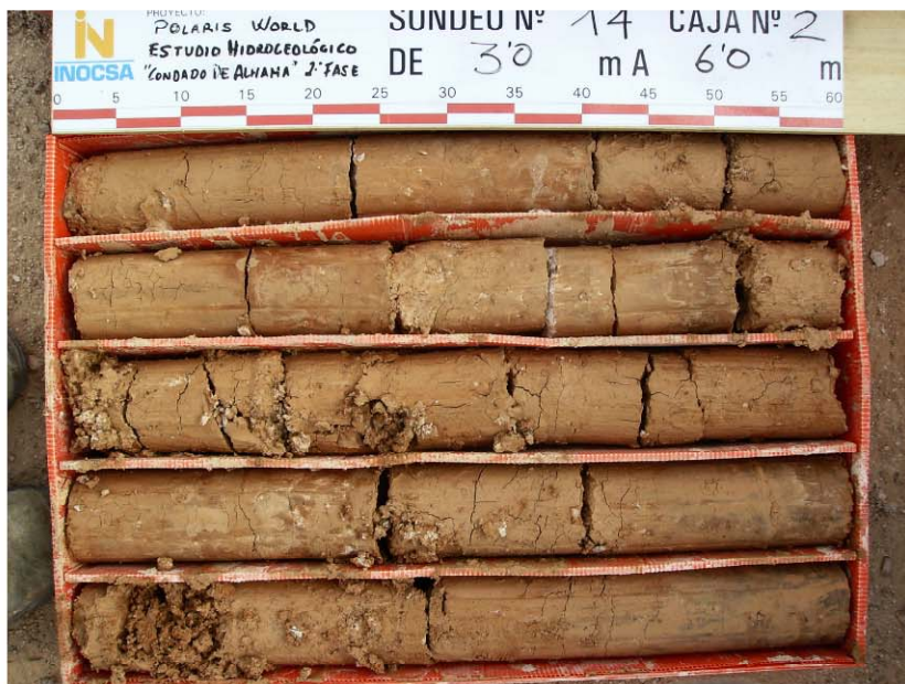
CAJAS DE TESTIGOS DEL SONDEO S-14 (0,0-6,0)
