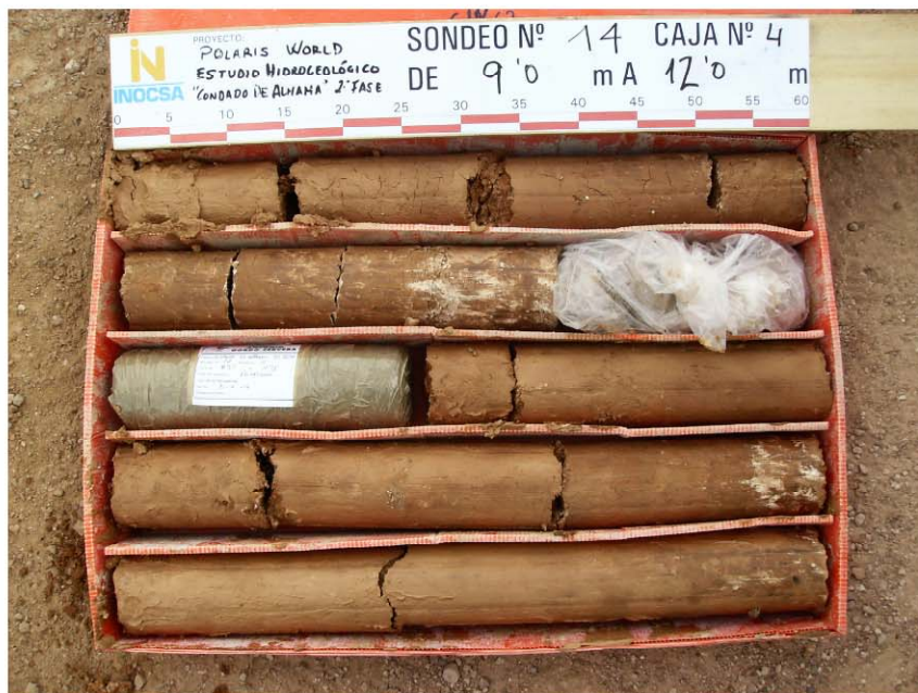
CAJAS DE TESTIGOS EN EL SONDEO S-14 (6,0-12,0)
