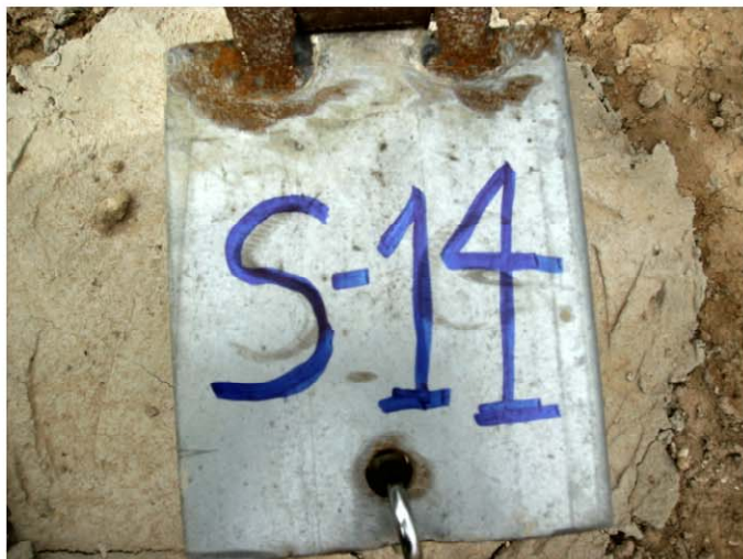
PIEZÓMETRO EN EL SONDEO S-14
