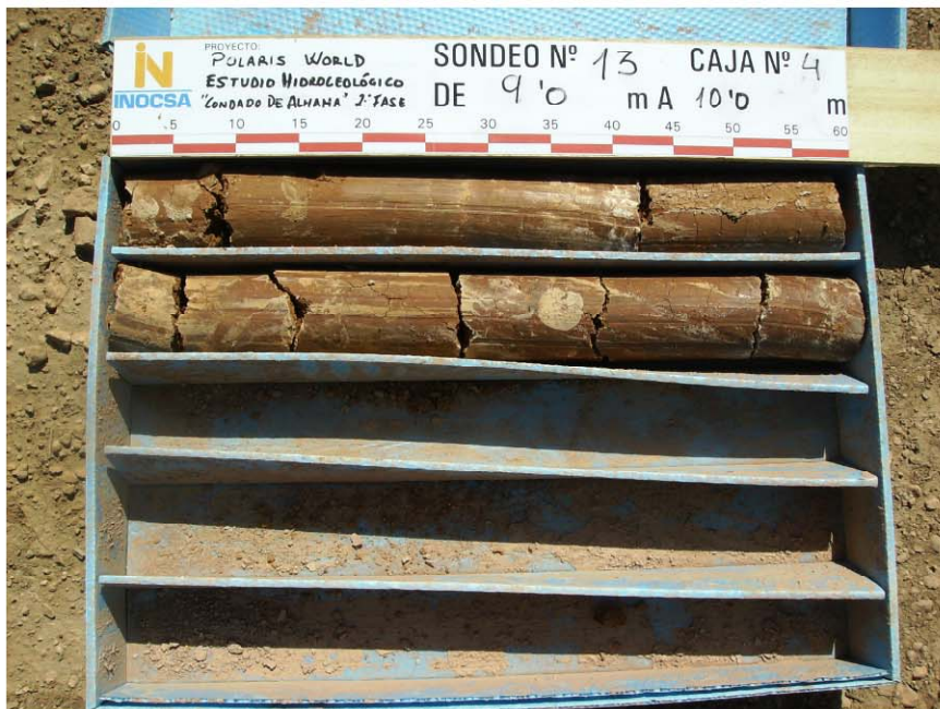
CAJAS DE TESTIGOS DEL SONDEO S-13 (6,0-12,0)
