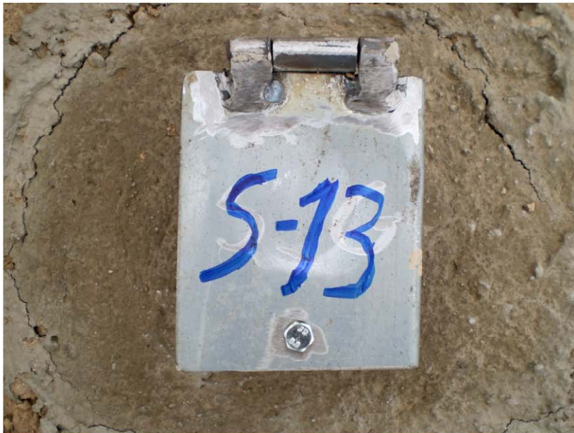
PIEZÓMETRO EN EL SONDEO S-13
