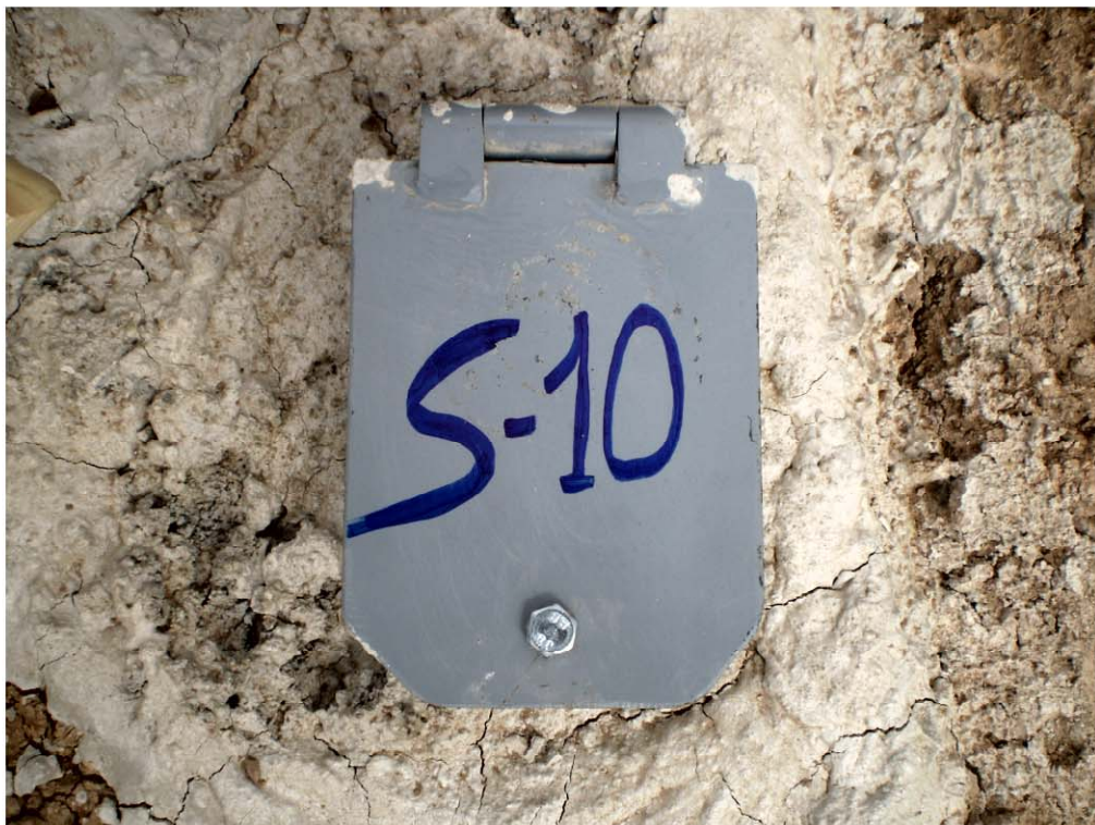
PIEZÓMETRO EN EL SONDEO S-10
