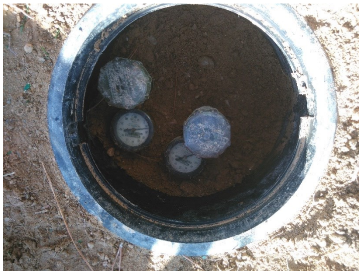
Fotografía de tensiómetros instalados el 02/06/2017
