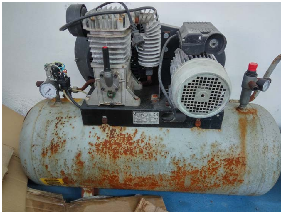
Ilustración 14: Compresor fijo 300l y 10 bares
