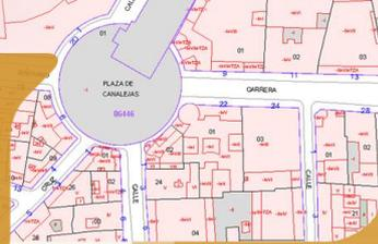
Cálculo de los parámetros de transformación a partir de las coordenadas de tres puntos de la realidad inmobiliaria obtenidas por levantamiento topográfico y la realidad encajada sobre un catastro desplazado.
